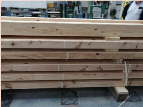
Les sciages ont été collés sous formes de poutres en Lamellé-Collé chez Gauthier Lamellé-Collé. Il y a donc des poutres de 3 qualités différentes.
